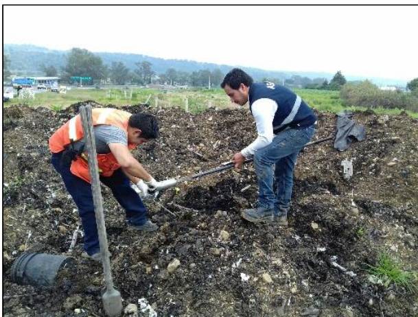
11.- Toma de muestra en celda provisional a una profundidad de 0.60 m.
