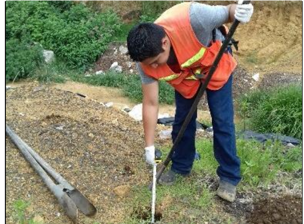
8.- Medición de profundidad de la toma de muestra en celda provisional.
