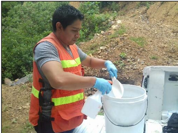
3.- El equipo fue lavado en cada toma de muestra para evitar una contaminación cruzada.
