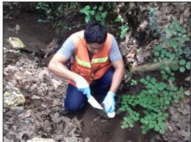
6.- Toma de muestra con cucharón de teflón a una profundidad superficial (0.10 m).
