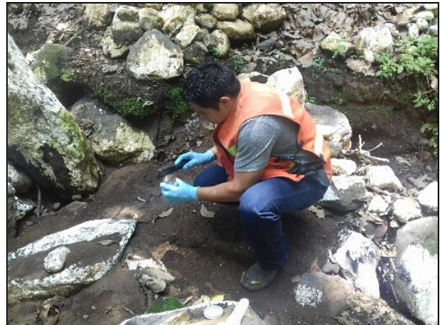
4.- Toma de muestra fosa de excavación (caja de extracción) con espátula de acero inoxidable.
