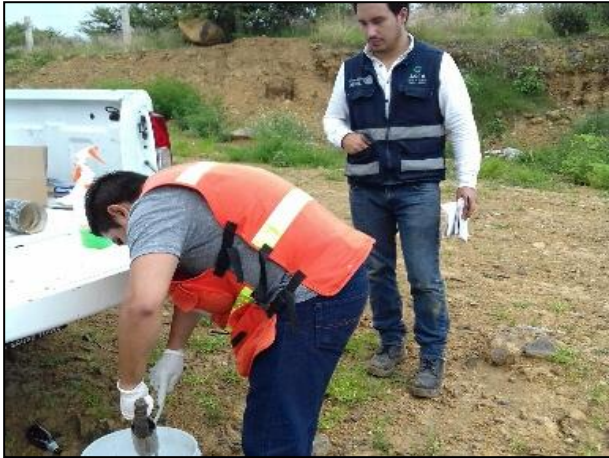
7.- Lavado de hand auger de acero inoxidable con jabón libre de fosfatos.
