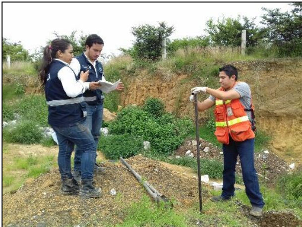
9.- Toma de muestra con hand auger en celda a una profundidad de 0.40 m.
