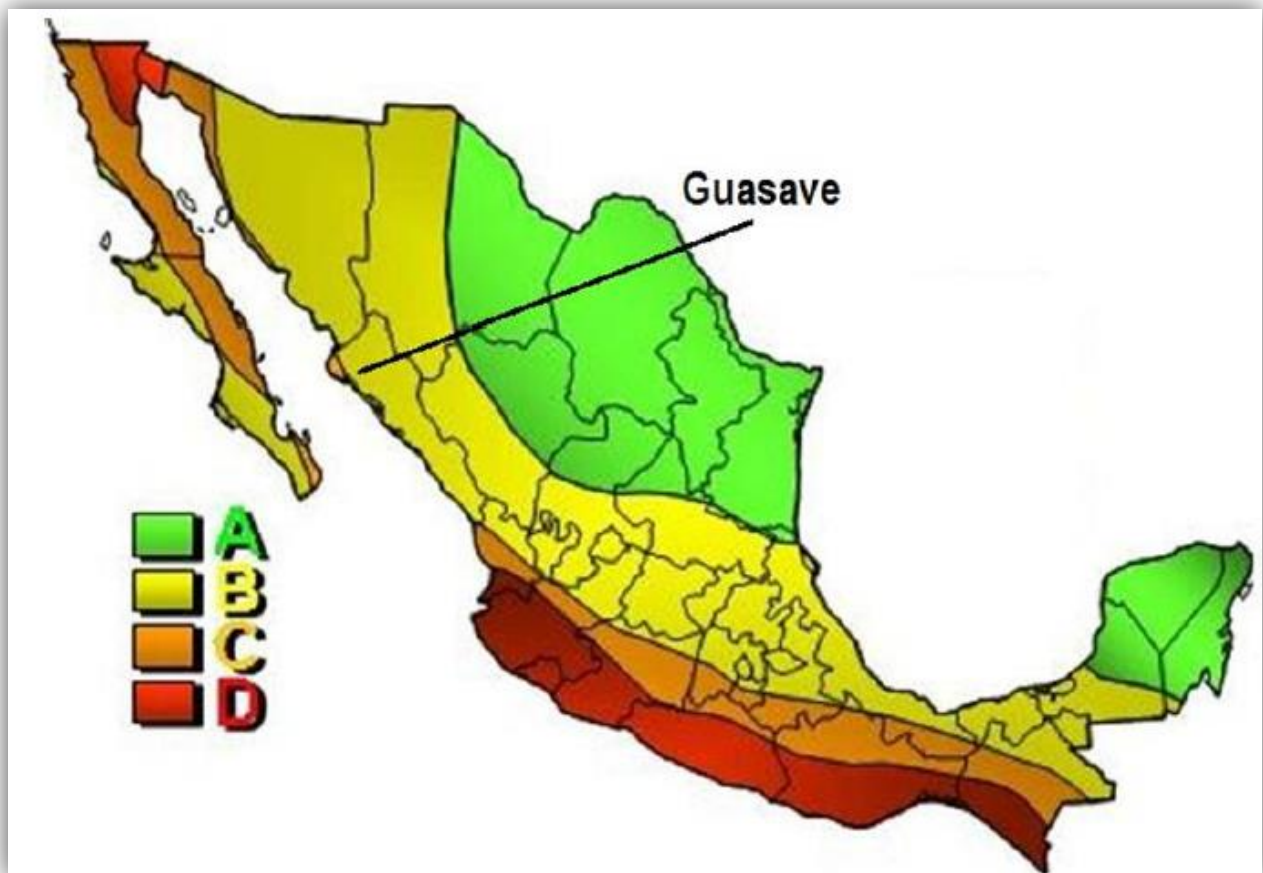
FIGURA 30: Regionalización sísmica de la República Mexicana (CFE, 2010). A: no se han reportado sismos en los últimos 80 años; B y C: sismos no tan frecuentes, son zonas afectadas por altas aceleraciones que no sobrepasan el 70% de la aceleración de la gravedad; D: se han reportado grandes sismos históricos, la ocurrencia de sismos es muy frecuente y las aceleraciones del suelo pueden sobrepasar el 70% de la aceleración de la gravedad.
