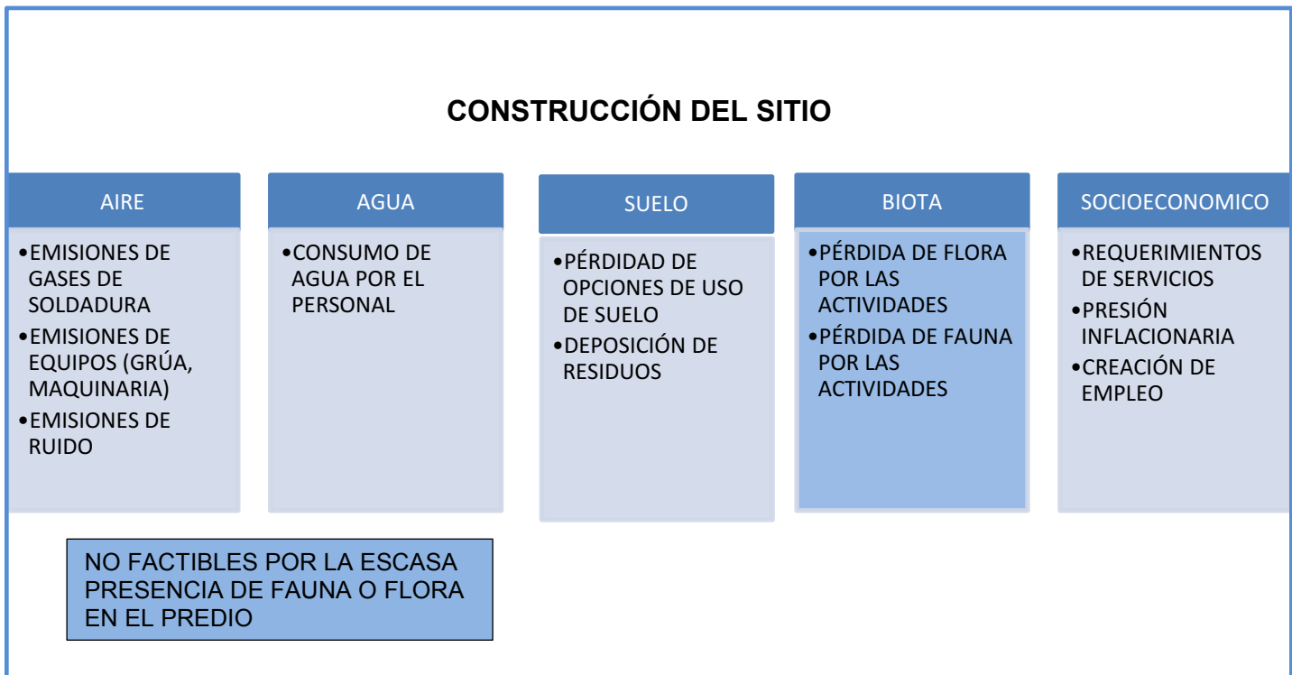
Figura V.2 Impactos asociados en la etapa de Construcción
