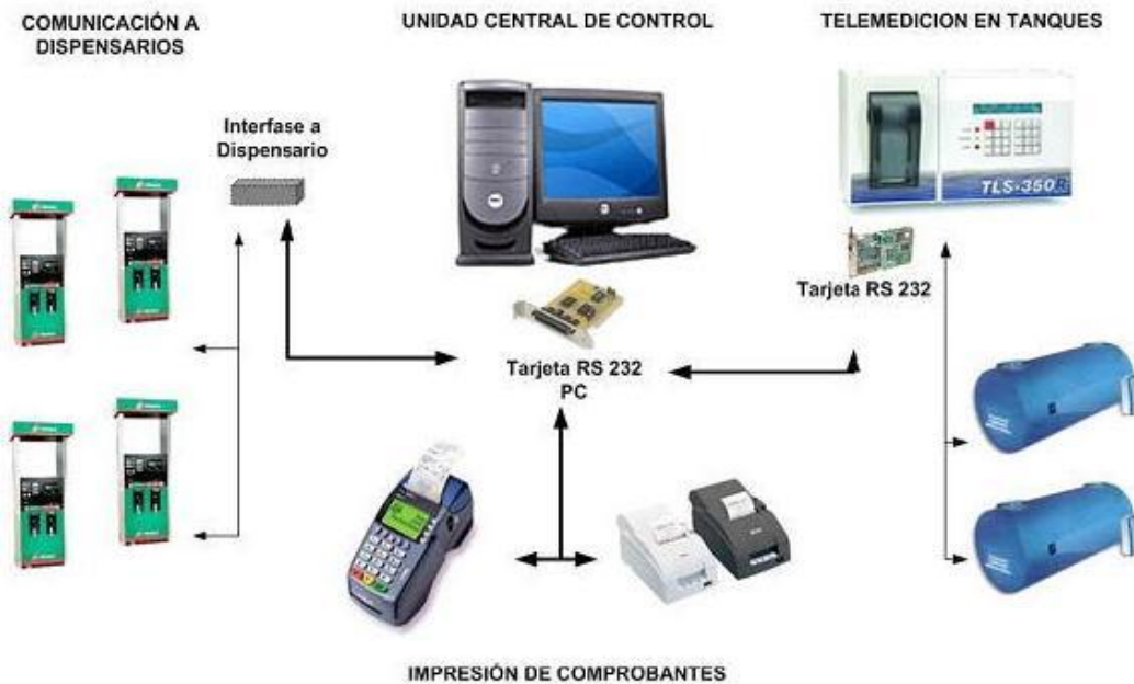
Imagen II. 11. Controles Volumétricos en Estaciones de Servicio.
