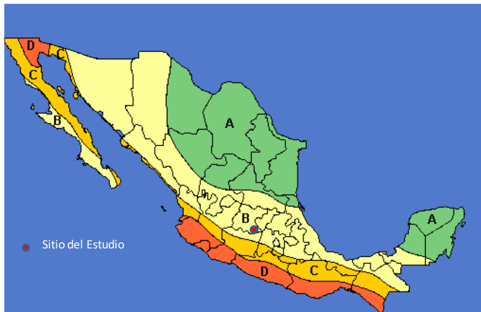
Figura 32. Regionalización Sísmica de la República Mexicana. El círculo señala la zona del proyecto.
