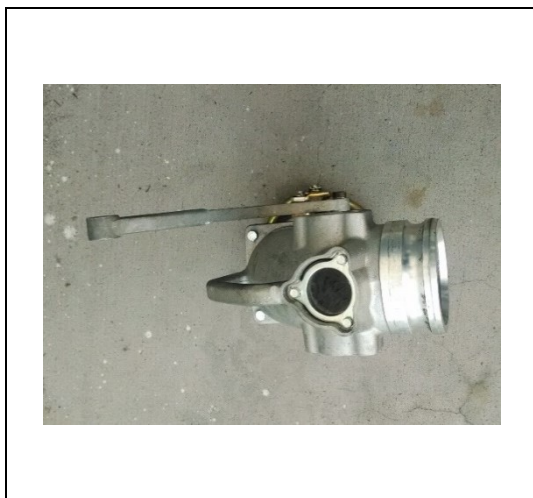
Vista superior del codo de descarga de combustible, sobre la cabeza del codo se ubica una mirilla que permite observar el flujo de combustible al momento de la descarga
