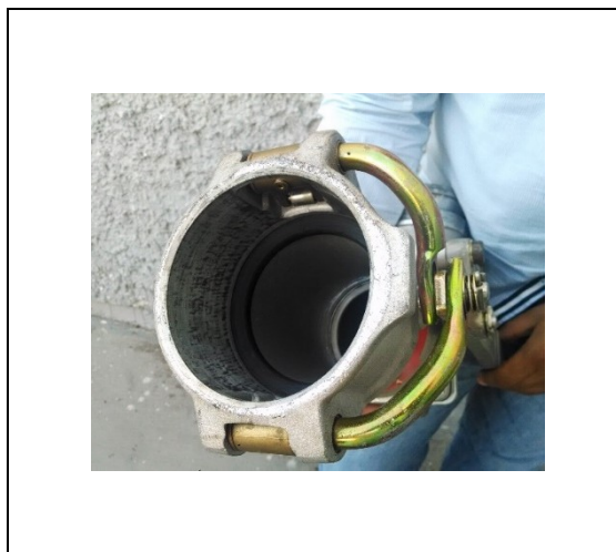
Detalle de los candados de sujeción, en el codo de descarga de combustible.
