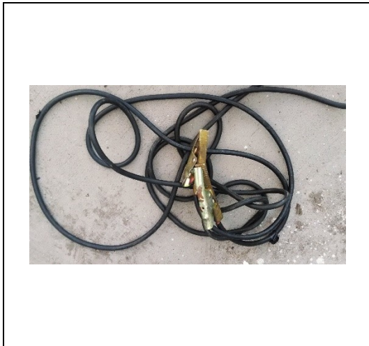
Cables para puesta a tierra y control de electricidad estática, se emplean al momento de la descarga, para prevenir la generación de chispas por descarga estática
