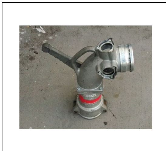
Vista del codo de descarga de combustible
