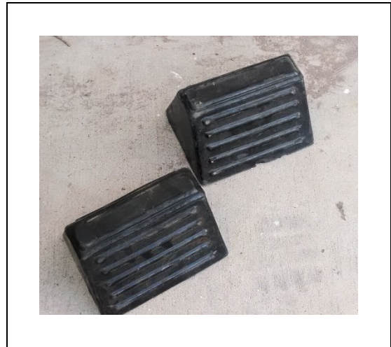
Tacones para llantas, se emplean al momento de la descarga para prevenir que el camión se mueva.
