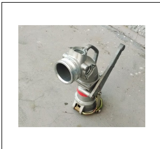
Vista del Codo para Descarga de Combustible, este implemento se coloca sobre el tanque de almacenamiento. Destaca la palanca empleada para ajustar los candados de sujeción.
