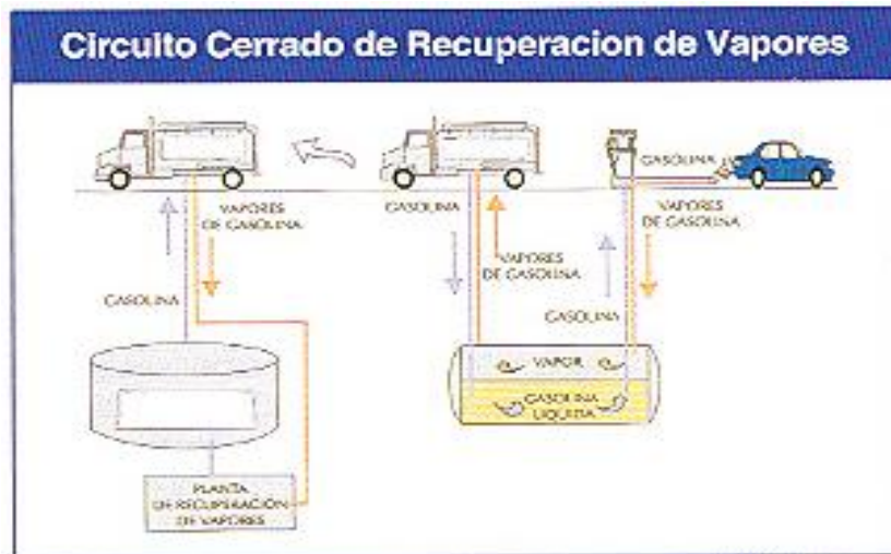
Figura 5. Funcionamiento del sistema de recuperación de vapores.
