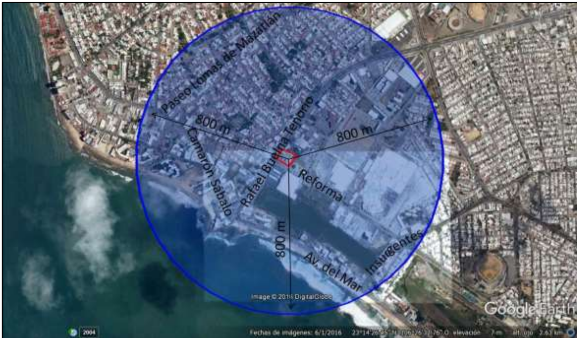
Figura 8. Área de Influencia de la Estación de Servicio a partir de la zona de tanques.
