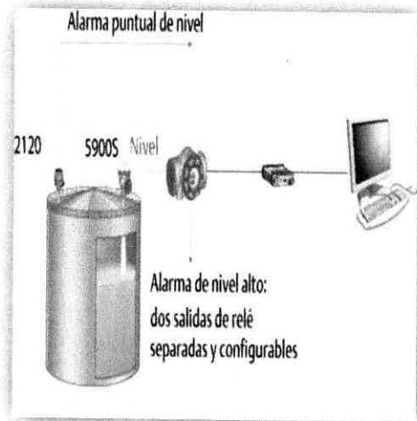
Imagen 19. La alarma de alto nivel y el mantenimiento preventivo a las alarmas y al sistema de detección de alto/bajo nivel evitan derrames de los tanques.
