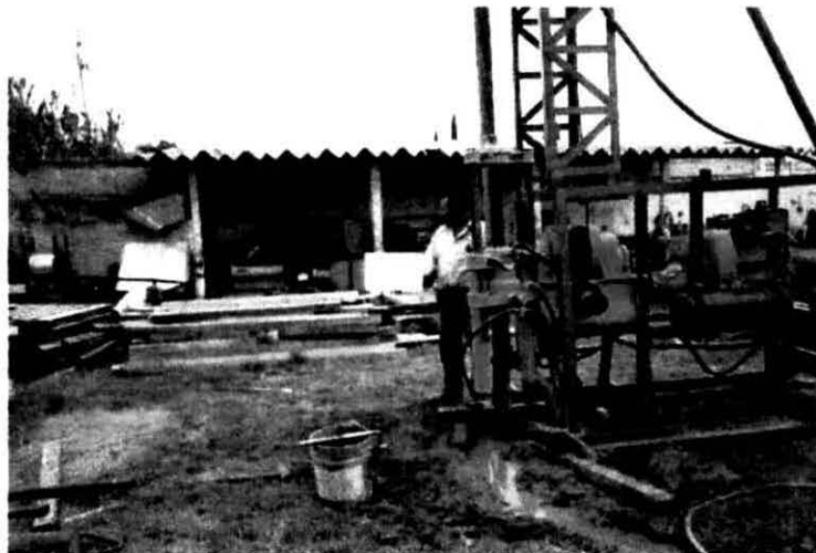
FOTO. 2 Muestreo mediante SPT-1
