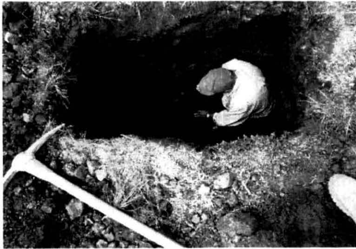
FOTO. 3 Realización del pozo a cielo abierto PCA-1
