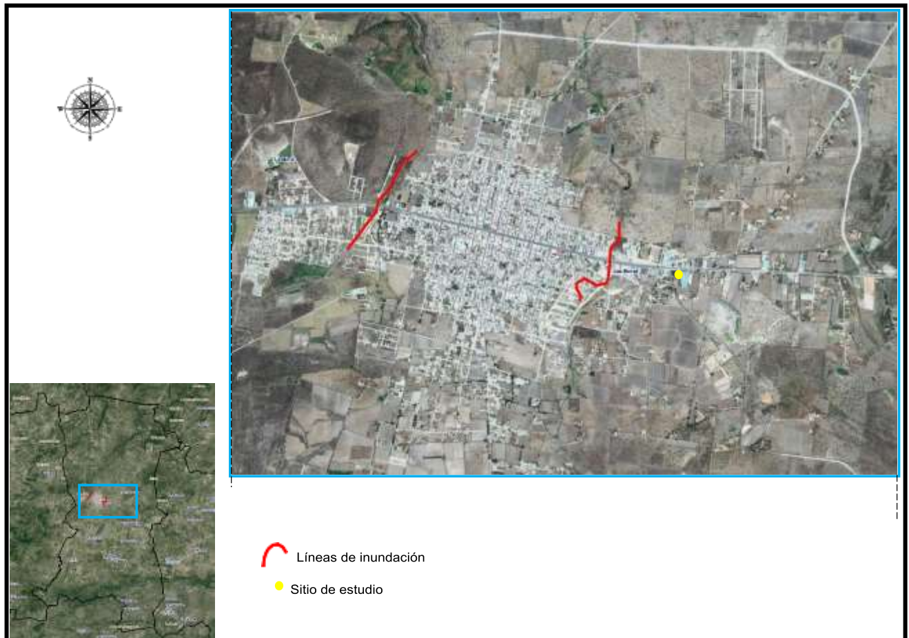
Figura 34. Zonas con riesgo de inundación del Municipio de San Julián. Líneas de inundaciones locales. Atlas de Riesgos del Estado de Jalisco.
