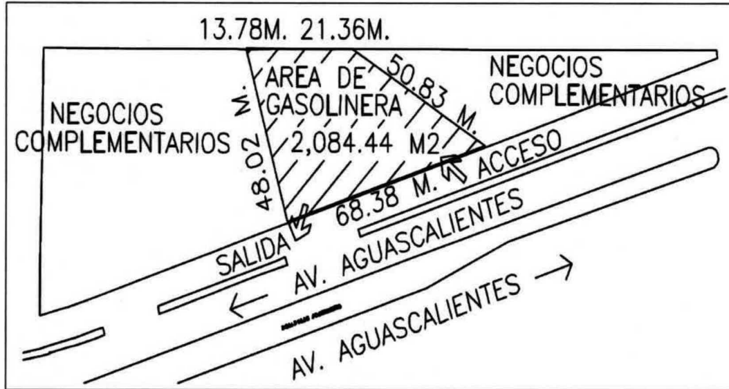
Fuente: Plano Arquitectónico Estación de Servicio GUTMART. Figura 7. Dimensiones Perimetrales de la Estación de Servicio GUTMART en Aguascalientes.
