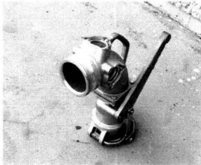
Vista del Codo para Descarga de Combustible, este implemento se coloca sobre el tanque de almacenamiento. Destaca la palanca empleada para ajustar los candados de sujeción.
