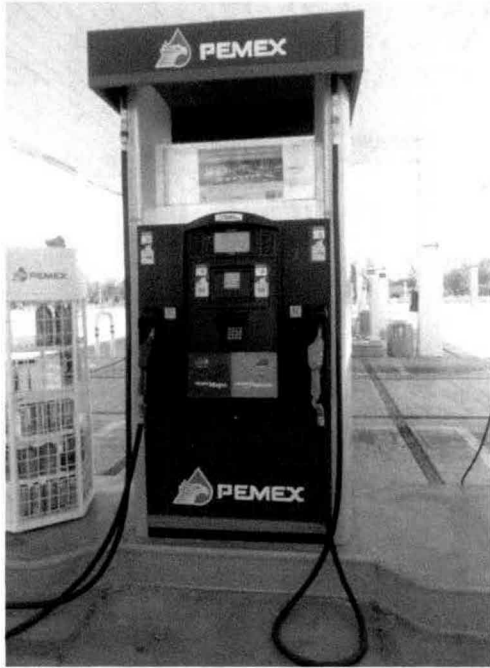
Dispensario 3-4: Dos mangueras para despacho de PEMEX Magna dos mangueras para despacho de PEMEX Premium.
