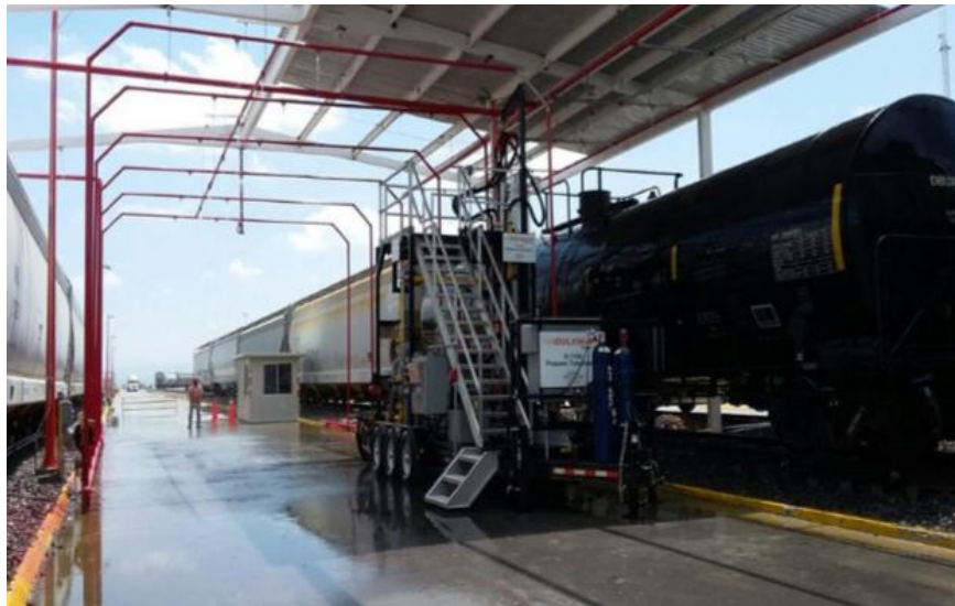
Figuras. Equipo Transloader para Trasvase de Gas L.P.
