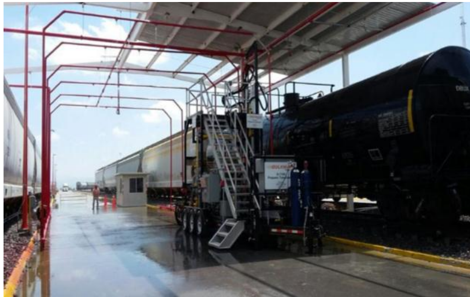
Figuras 15. Equipo Transloader para Trasvase de Gas L.P.
