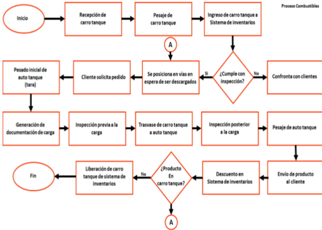
Fuente: Elaboración propia Figuras 17. Diagrama de Flujo de Trasvase para combustibles líquidos.
