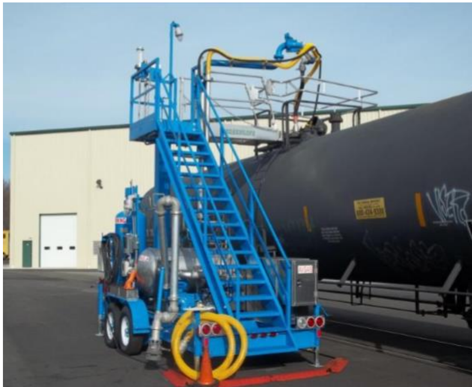
Fig. 11. Equipo Transloader para trasvase de diésel y gasolina
