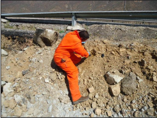
7. Toma de muestra testigo con cucharón de teflón.
