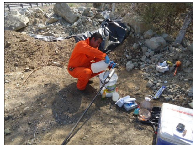
6. El equipo de muestreo fue lavado entre cada toma de muestra para evitar la contaminación cruzada.
