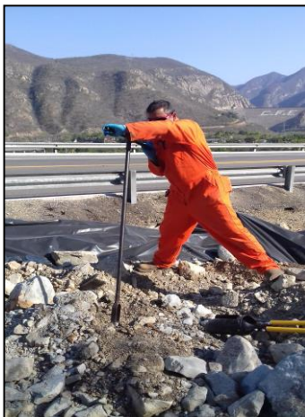
5. Con ayuda de hand auger de acero inoxidable se tomaron las muestras en la celda provisional.
