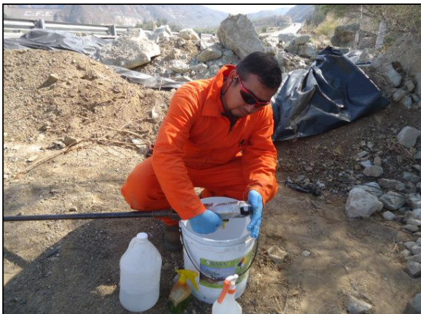
3. Lavado del equipo de muestreo con jabón libre de fosfatos y agua destilada.
