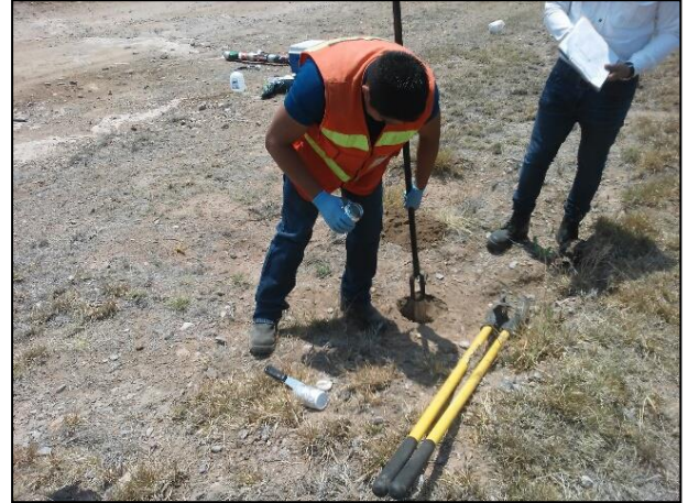
2.- Se tomaron muestras con hand auger de acero inoxidable a una profundidad de 0.30 m.
