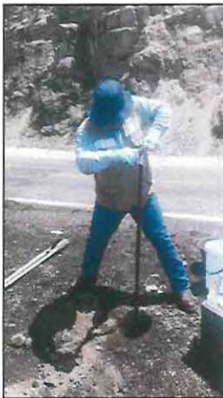
Con ayuda de hand auger de acero inoxidable se tomaron las muestras en el área impactada.
