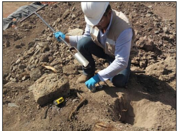
6 - Se tomaron muestras en el suelo dañado depositado en la celda provisional.
