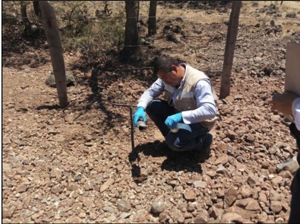
1 - Se tomaron muestras en el fondo de la fosa de excavación con hand auger.
