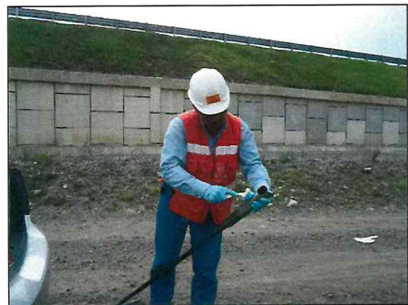
Entre cada toma de muestras el equipo utilizado se lavó con agua destilada y jabón libre de fosfatos
