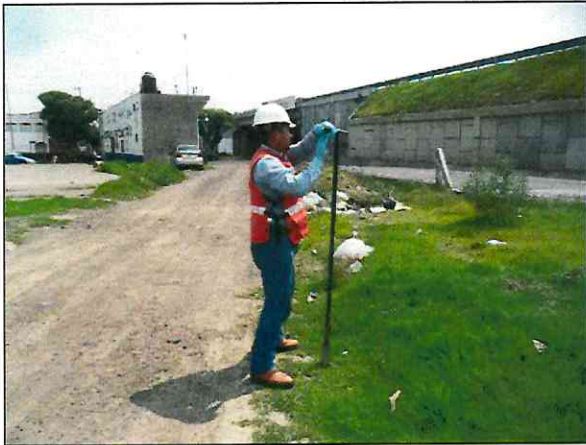
Con hand auger se tomaron las muestras en el área impactada
