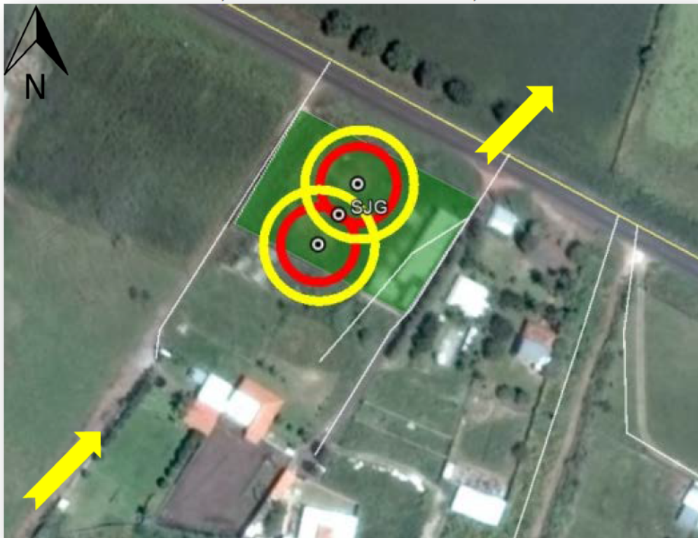
Figura 24. Zona de afectación por un incendio de la gasolina derramada en la zona de dispensarios, el círculo rojo indica el área afectada por la radiación térmica con 1,500 \text{ BTU/pie}^2 \text{ h} , y el círculo amarillo la zona afectada por la radiación térmica con 440 \text{ BTU/pie}^2 \text{ h} , zona que se ubica dentro de la estación de servicio, no habiendo daños al entorno por este escenario.
