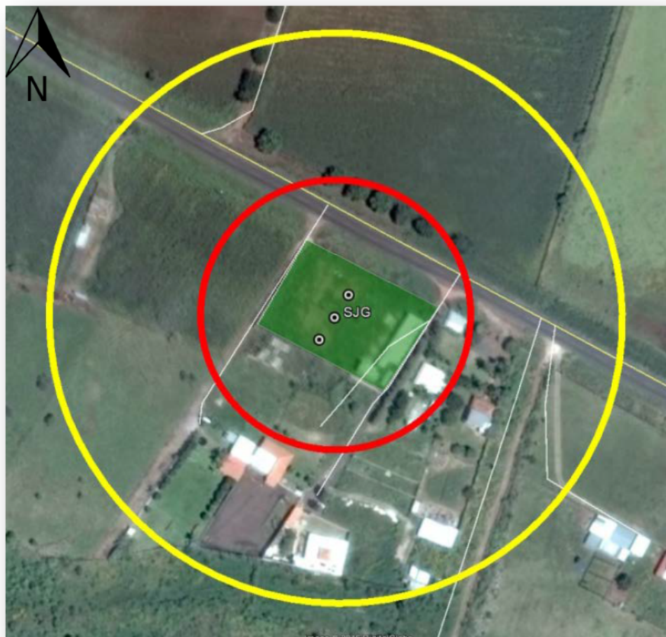
Figura 22. Área de afectación por una UVCE derivada por la explosión de una pipa, el círculo rojo muestra la zona de fatalidad, y el círculo amarillo la zona de heridos
