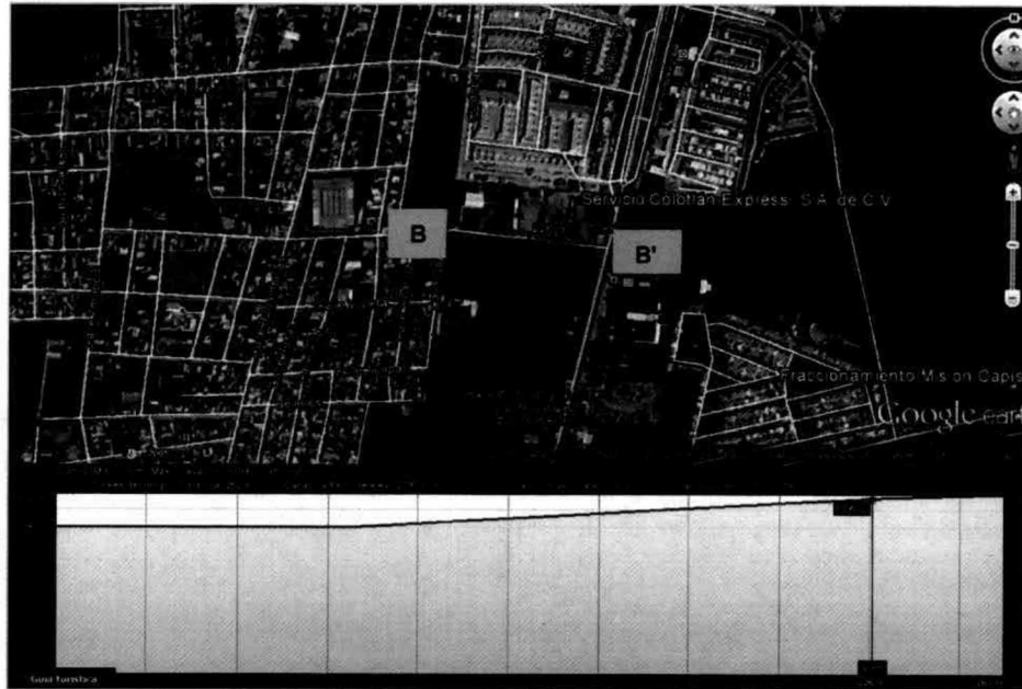
Imagen 61. Análisis del perfil de elevaciones del segmento B - B', ubicado sobre la Calle Girasol.
