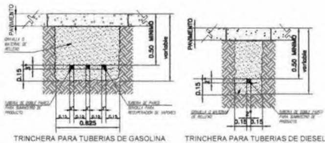
Figura 18. Trincheras para instalación de gasolina y diésel. Sin escala.
