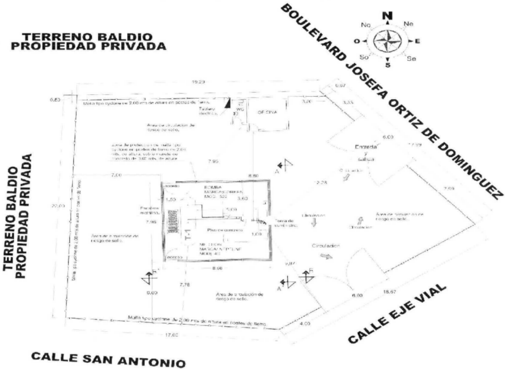
Figure 10. Plano de arreglo de áreas en la estación de carburación proyectada.
