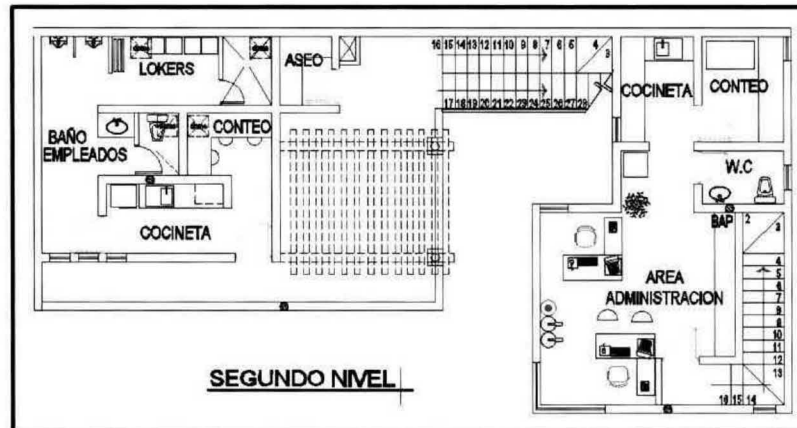
Imagen 2. Segundo nivel del área de servicios administrativos.
