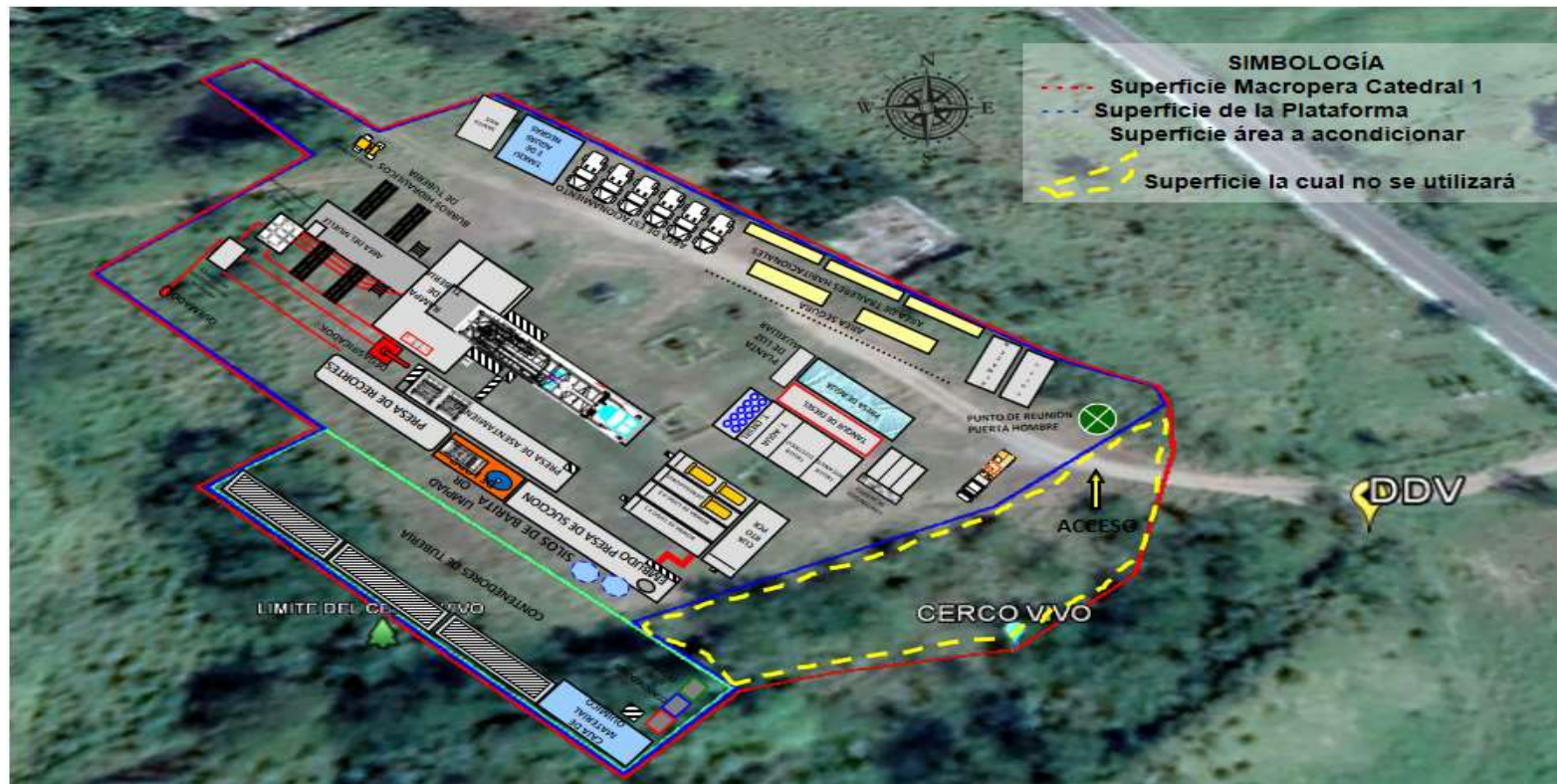
Figura 1.6 Distribución esquemática preliminar del equipo de perforación, considerando la superficie que se requiere acondicionar (no representa las dimensiones reales del arreglo de los componentes del equipo de perforación).
