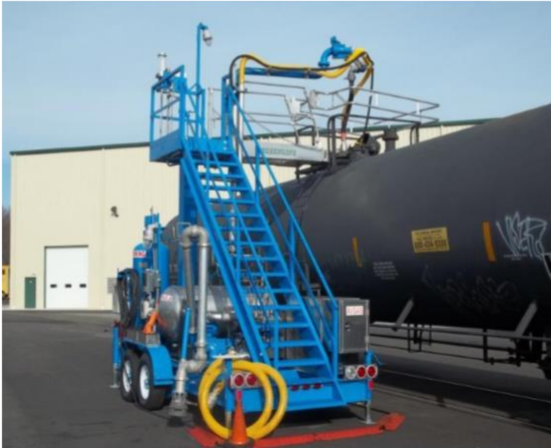
Fig. 4. Equipo Transloader para trasvase de diesel y gasolina
