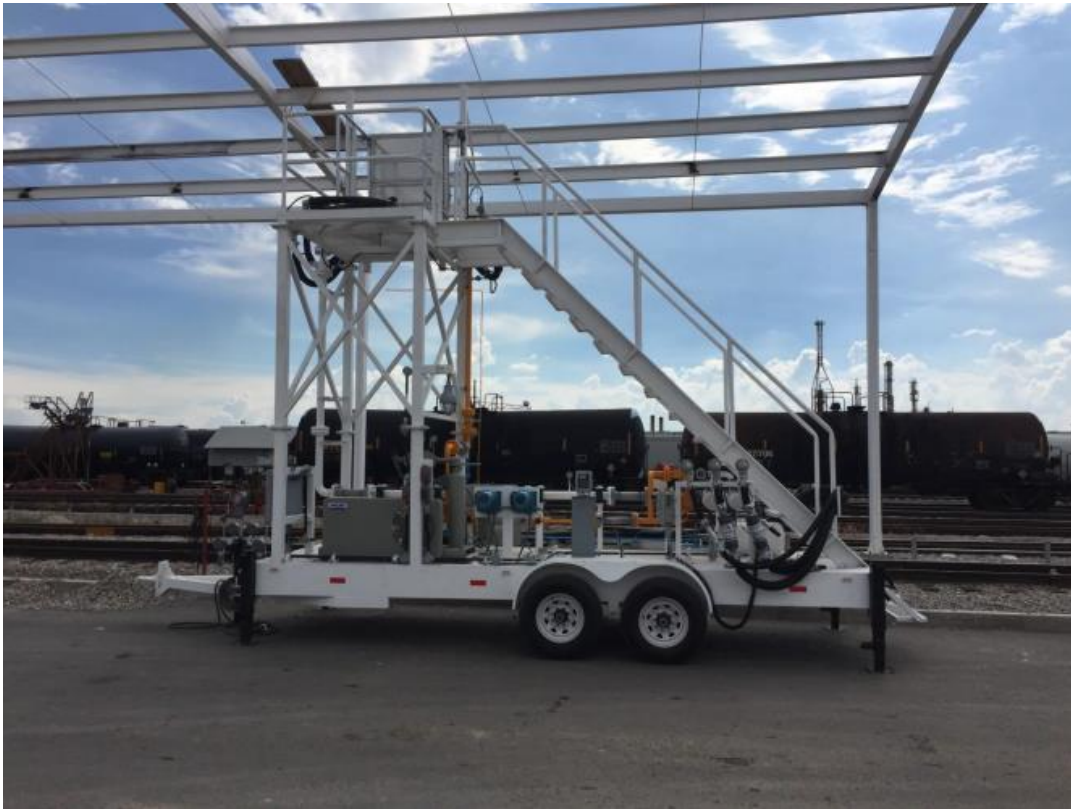
Fig. 3. Equipo Transloader para trasvase de gas L.P.
