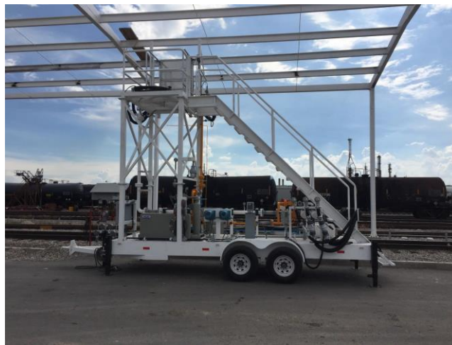
Figuras 16. Equipo Transloader para Trasvase de Gas L.P.
