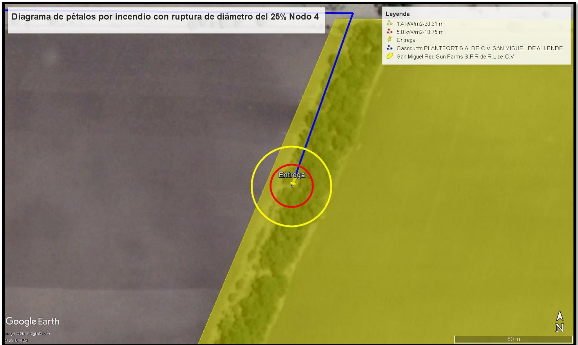
Figura 37. Diagrama de pétalo de incendio en el nodo 4 con ruptura de diámetro del 25%.
