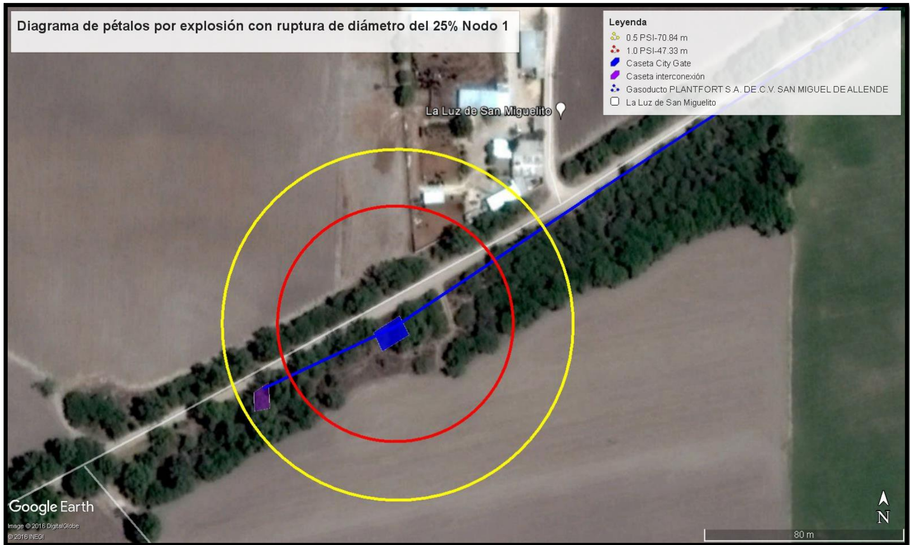
Figura 21. Diagrama de pétalo de simulación por explosión en el nodo 1 con ruptura de diámetro del 25%.
