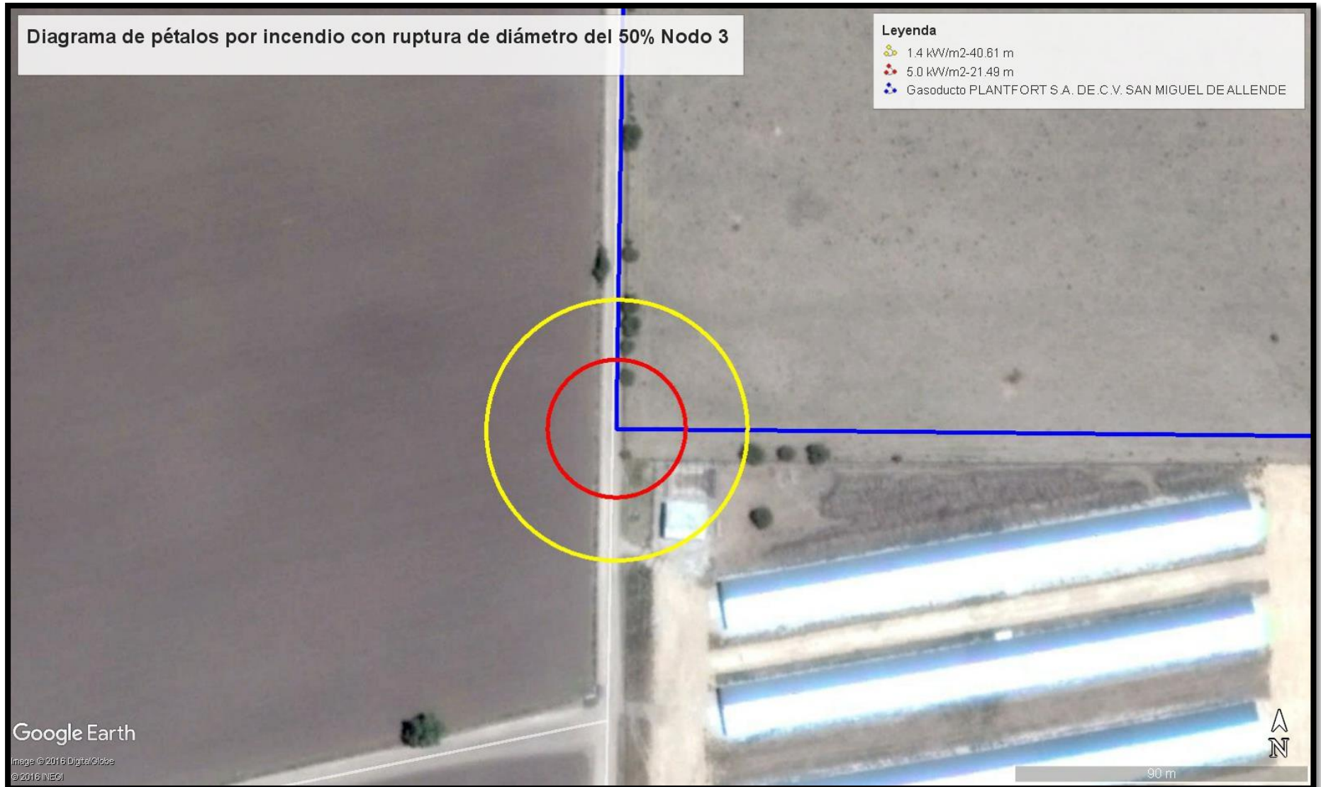
Figura 32. Diagrama de pétalo de incendio en el nodo 3 con ruptura de diámetro del 50%.
