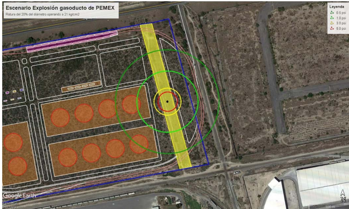
Fig 103. Escenario de explosión por rotura del 20% de gasoducto PEMEX en Tas Escobedo
