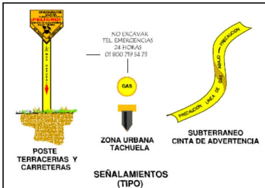
Figura 4. Señalización a colocar sobre derecho de vía del gasoducto de transporte de gas natural.
