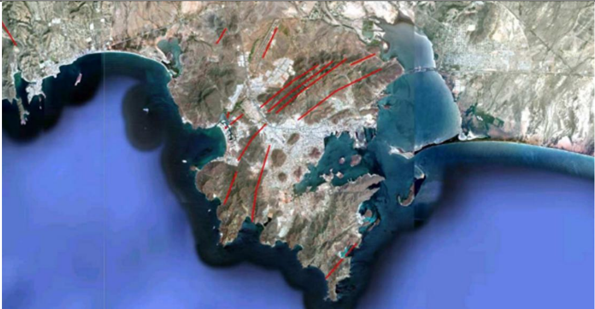
Figura 4-6 Fallas identificadas en las elevaciones contenidas en la Ciudad de Guaymas
