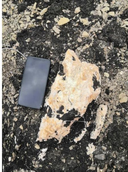
*Figura 5. Cristalización de calcita en espacios sigmoidales que resultan del esfuerzo de cizalla en las lutitas de la formación Méndez.*
