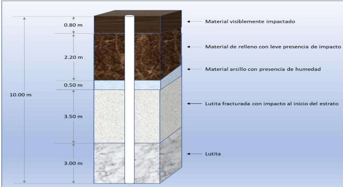
Figura 26. Columna estratigráfica construida partir de los registros de perforación del km 304+000
