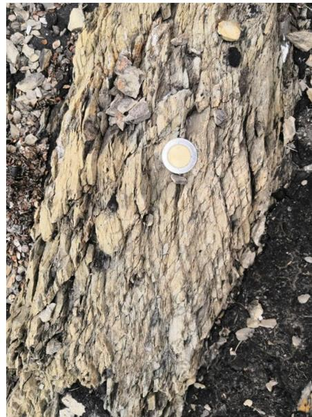
Figura 3. Foliación diagonal en lutitas como resultado de esfuerzos de cizalla
