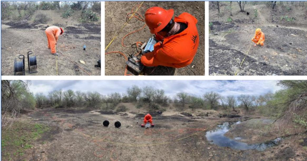
Figura 13. Instalación y lectura de perfiles de tomografías
