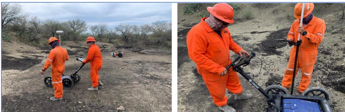
Figura 17. Levantamiento con georradar
