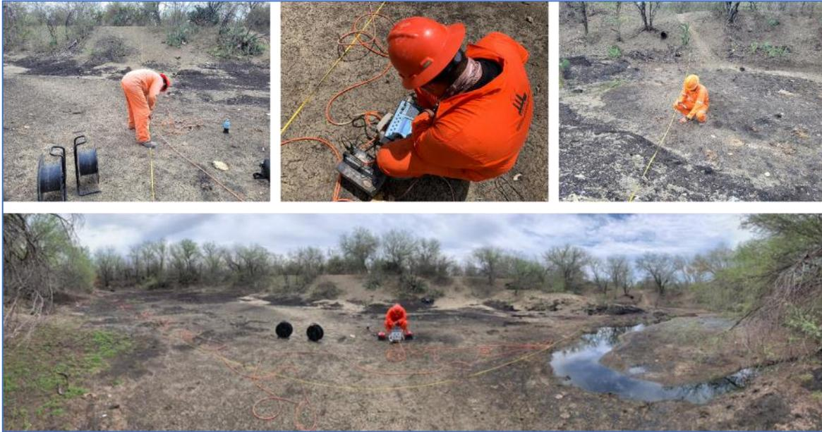
Figura 11. Instalación y lectura de perfiles de tomografías
