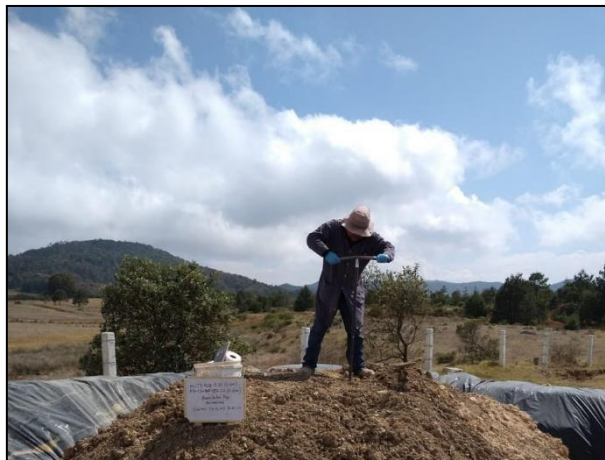
10. Se realizó la toma de muestras duplicado para aseguramiento de la calidad de estas. Toma de muestras dentro de la Celda Provisional.
