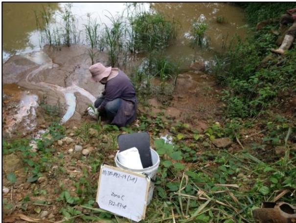
15. Toma de muestra de sedimento con apoyo del Hand Auger.
