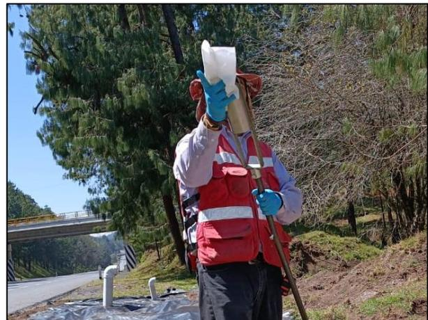
12. Se lavó el equipo de muestreo utilizado, entre cada toma de muestra, para evitar la contaminación cruzada de las mismas.
