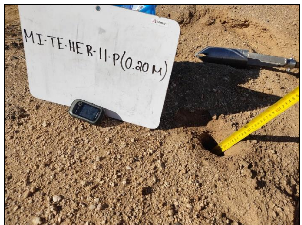
06. Las profundidades de los puntos de muestreo fueron verificadas con apoyo de flexómetro.
