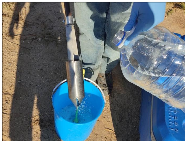
10. El personal encargado de la toma de muestras lavó el equipo de muestreo utilizando jabón libre de fosatos, entre cada toma de muestras.
