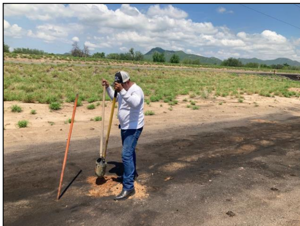
04. Se realizaron sondeos en el sitio en estudio a fin de determinar la pluma del contaminante.
