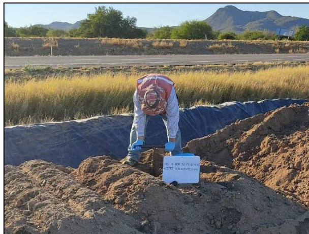
14. Se realizó la toma de muestras dentro de la Celda Provisional, con ayuda de Hand Auger.
