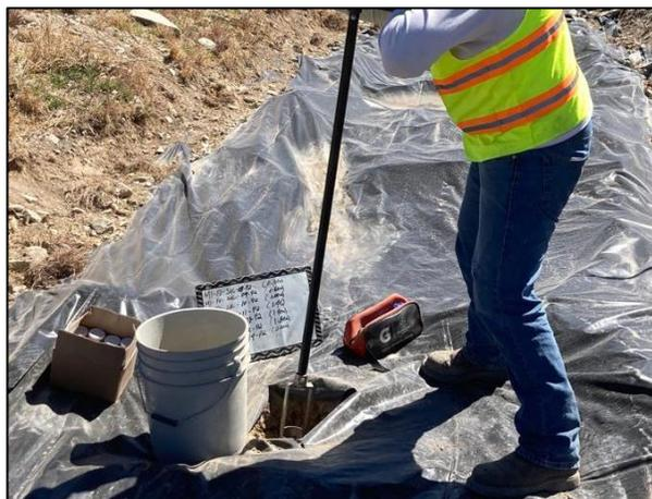
06. Toma de muestras dentro de la Zona afectada, con apoyo de Hand Auger.
