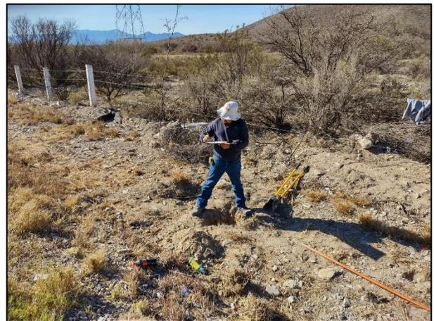
5. Las coordenadas de los vértices de la mancha provocada por el contaminante fueron determinados con apoyo de un GPS.
