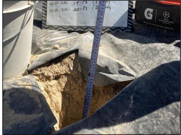
08. Las profundidades de los puntos de muestreo fueron verificadas con apoyo de flexómetro.
