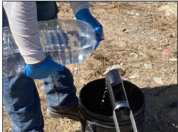
12. Se lavó el equipo de muestreo utilizado, entre cada toma de muestras, para evitar la contaminación cruzada de las mismas.
