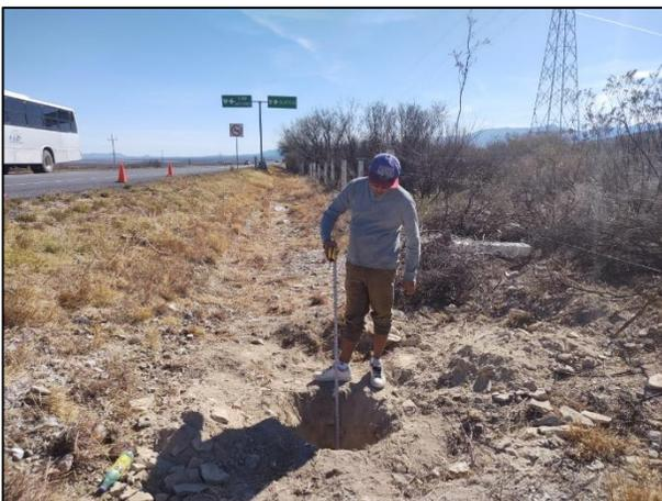
4. Se identificó la infiltración del hidrocarburo con ayuda de un flexómetro.
