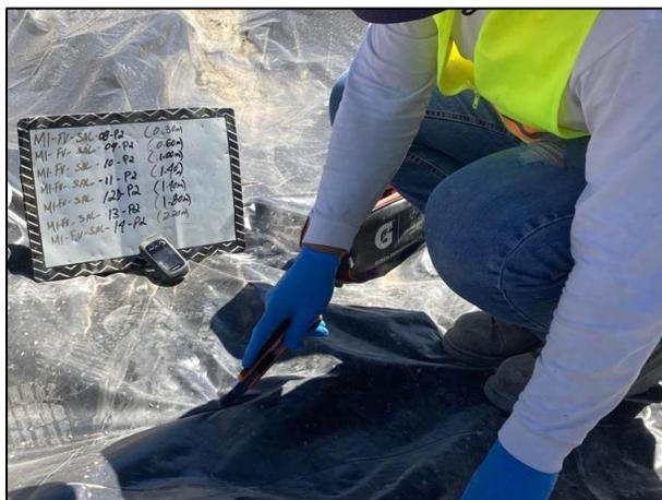
05. Se realizaron cortes en la película de polietileno de alta densidad para la toma de muestras dentro de la Zona afectada.
