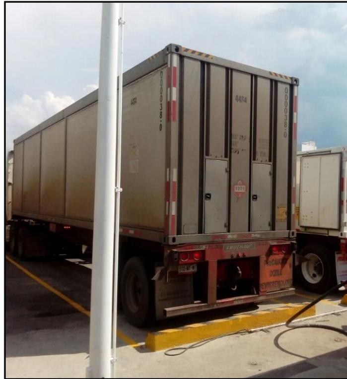
Figura 5. Semirremolque industrial para el transporte de Gas Natural Comprimido.
