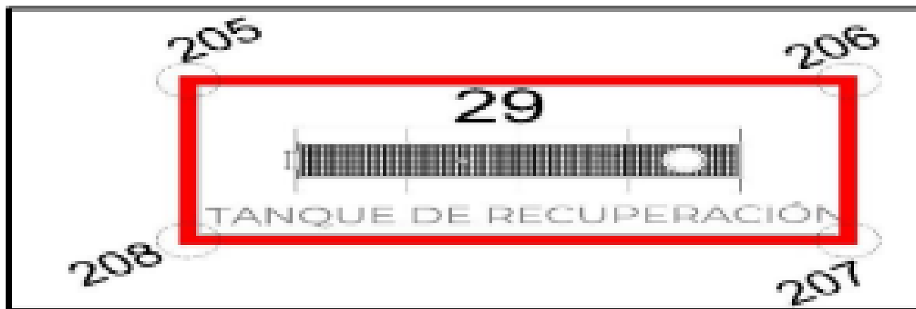
Figura II.23 Tanque horizontal para recuperación de combustible
