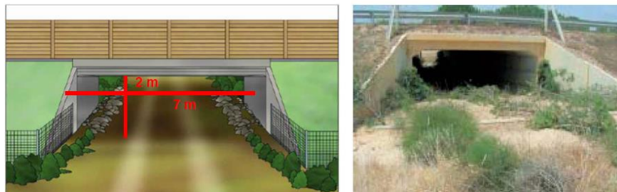
Figura VI.7 Esquema general de paso superior para fauna tipo 1.
