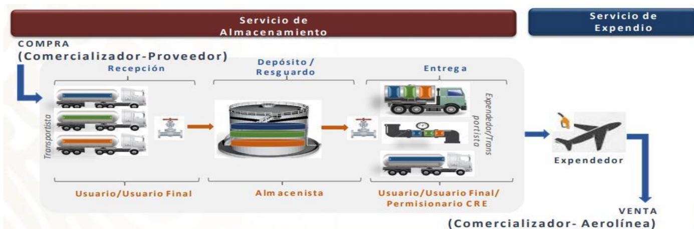
Figura II.27 Etapa de recepción, almacenamiento y entrega de Turbosina.
