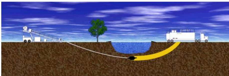
FIGURA 30. REPRESENTACIÓN DE LA AMPLIACIÓN DE LA PERFORACIÓN PILOTO.
