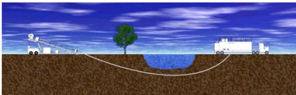
FIGURA 29. REPRESENTACIÓN DE UN ORIFICIO PILOTO.
