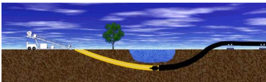
FIGURA 31. REPRESENTACIÓN DE CÓMO LA TUBERÍA ES JALADA PARA LLEGAR AL EXTREMO OPUESTO.
