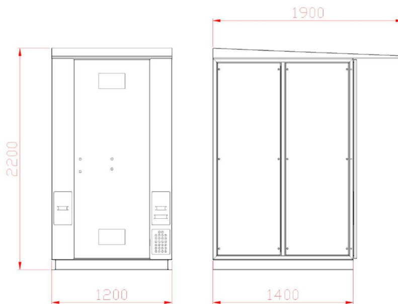
Figura 16: Dimensiones del tablero de control.
