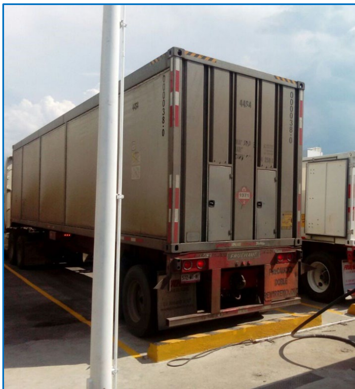
Figura 20: Semirremolque industrial para el transporte de Gas Natural Comprimido.
