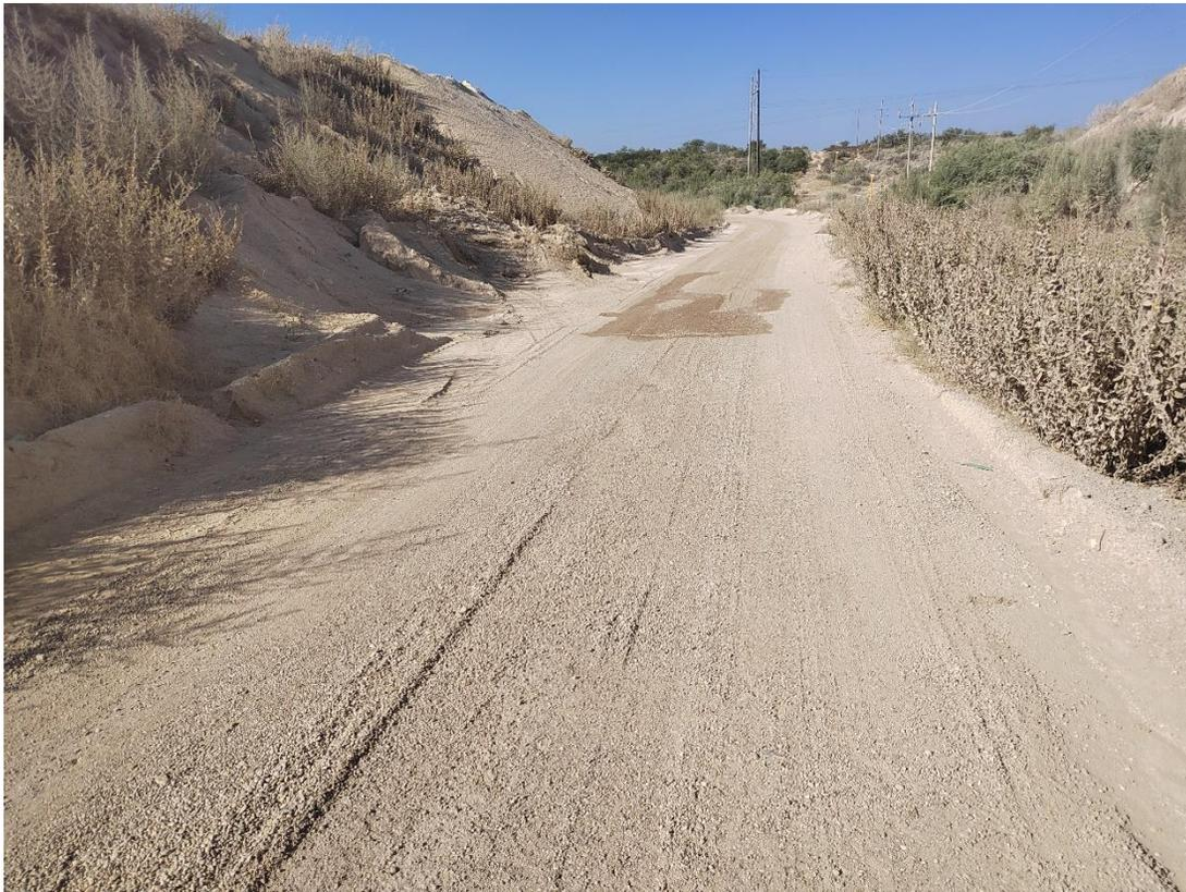
**Foto 1. Camino de terracería existente, y que es empleado por las empresas dedicadas a la producción de asfalto para el acarreo de la materia prima, apreciándose que se encuentra desprovisto de vegetación y cuenta con las dimensiones suficientes (7 m de ancho) para poder albergar las actividades de preparación del sitio y construcción del Proyecto, ya que para tal fin solo son necesarios 3 m de ancho sobre la trayectoria del STGN.**
