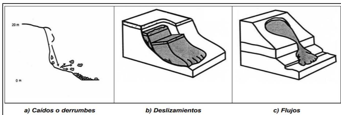
Fig. 75. Movimientos de masa – Deslizamientos
