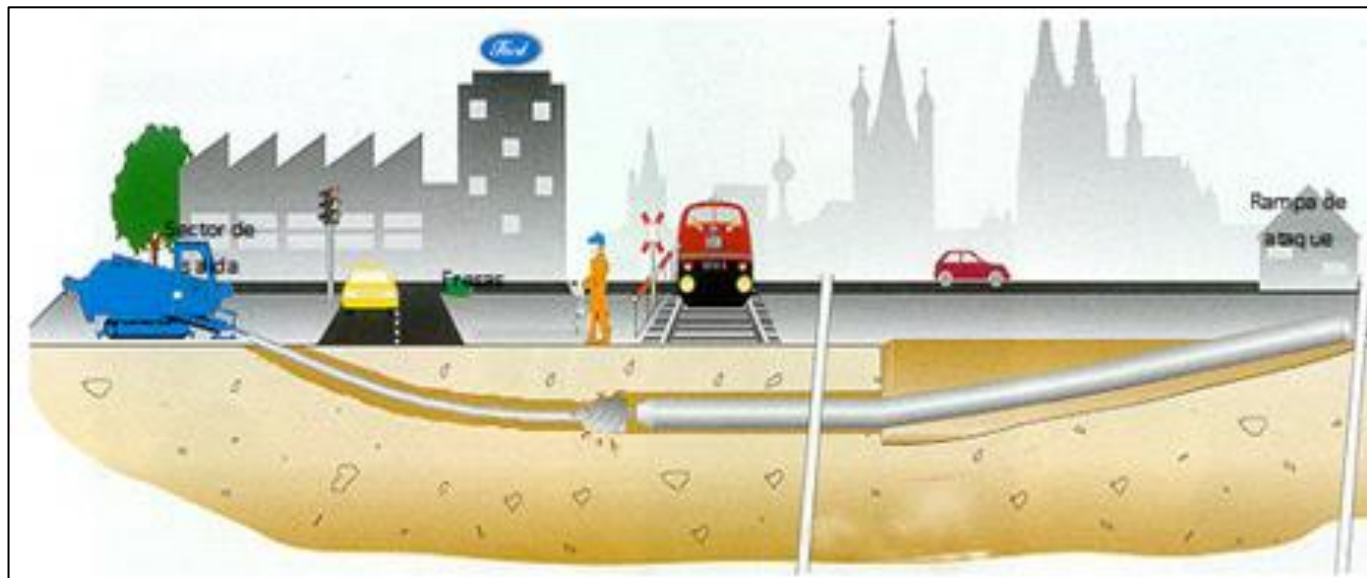
Fig. 32. Técnica de perforación direccional.
