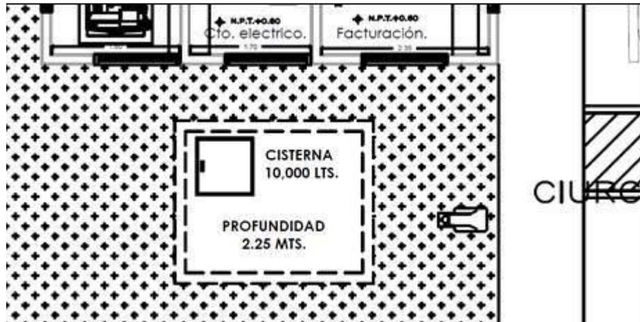
**Figura III. 6.-** Cisterna para almacenamiento de agua potable.
