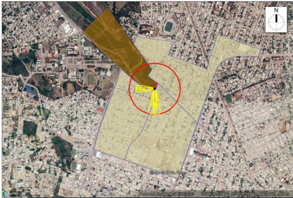
Fig. III.11. AI-D de un radio de 304 m obtenidos de la influencia máxima del análisis de riesgo con las AGEB afectadas.
