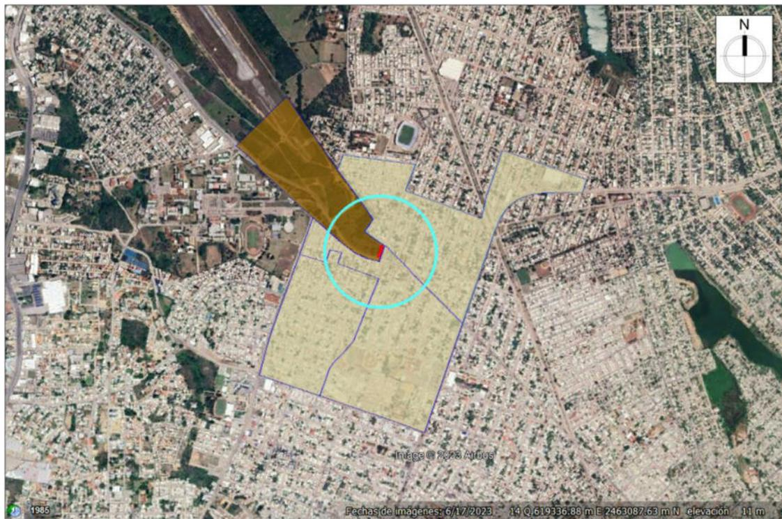
Fig. III.10. AI-D de un radio de 340 m obtenidos de la influencia máxima del ruido con las AGEB afectadas, durante la construcción.
