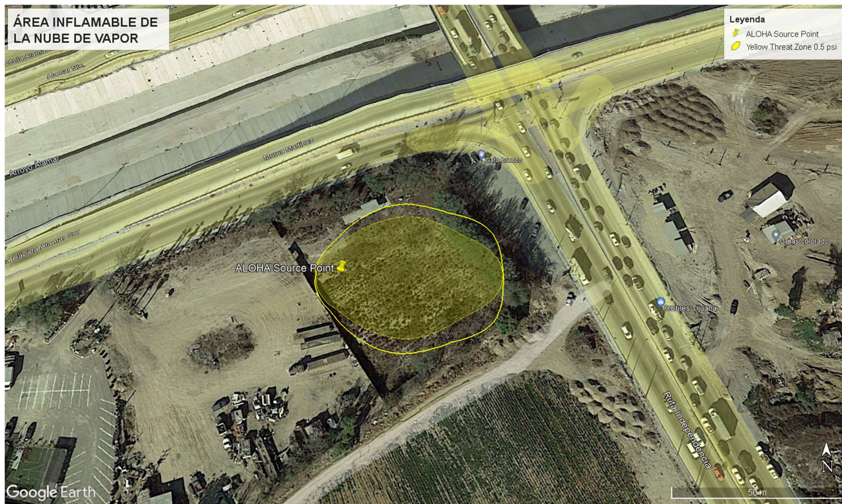
Figura 35. Área de explosión de la nube de vapor
